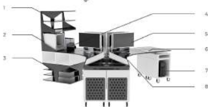
1. ВЕРХНИЙ ШКАФ 2. 3D-ПРИНТЕР 3. НИЖНИЙ ШКАФ 4. ПРИНТЕР 5. МОНИТОР 6. ПЛАНШЕТ 7. СТАНЦИЯ 8. ДОСКА
